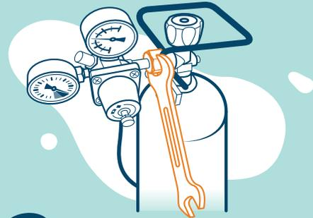
**2** Mit dem Gabelschlüssel den Druckregler gegen den Uhrzeigersinn lösen
