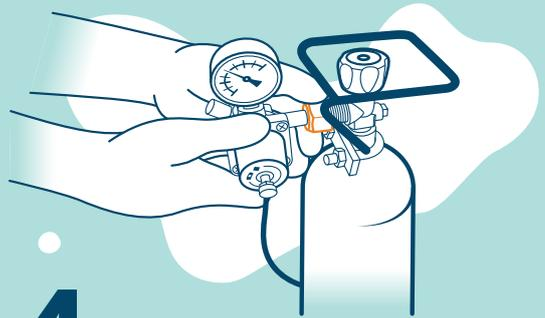
**4** Druckregler handfest anschrauben und mit dem Gabelschlüssel leicht festziehen
