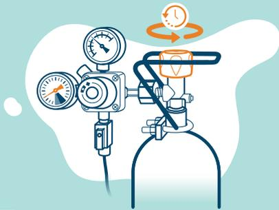
**5** Ventil der vollen CO<sub>2</sub>-Flasche gegen den Uhrzeigersinn aufdrehen (3 Umdrehungen). Das Manometer sollte 50-60 bar anzeigen.
