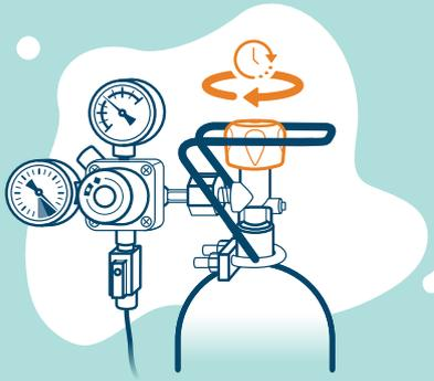
**1** Ventil der leeren CO<sub>2</sub>-Flasche im Uhrzeigersinn bis zum Anschlag schließen
